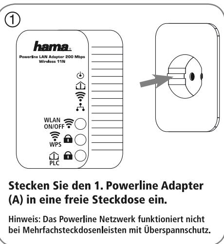
Stecken Sie den 1. Powerline Adapter (A) in eine freie Steckdose ein.
